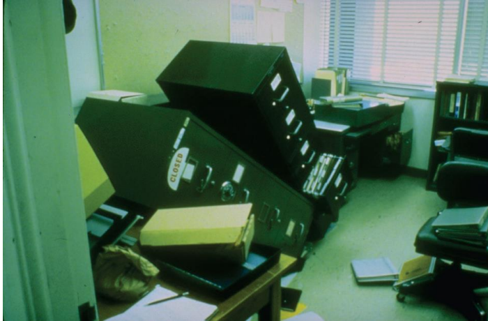
איור 2-6.5.5.1 – נזק לציוד משרדי עקב רעידת אדמה.
