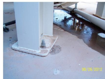
איור 4-6.4.2.1 – מיכלים ביקב שנפגעו ברעידת אדמה. ניתן לראות כשלים שונים: כשל בעיגון ברגים, כשל בקריסה של רגלי התמיכה, כשל בריתוכים. שימוש בברגים לפילוס גובה המיכלים גרם ליצירת אזור חלש בין תחתית הרגלים לרצפת חלל האחסון.
